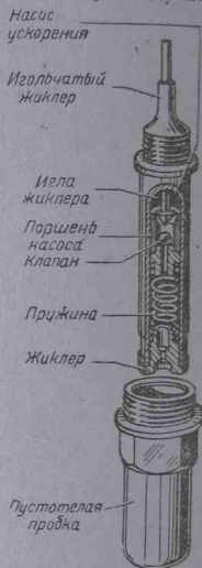
Фиг. 88. Общий вид и устройство насоса ускорения Амал.
