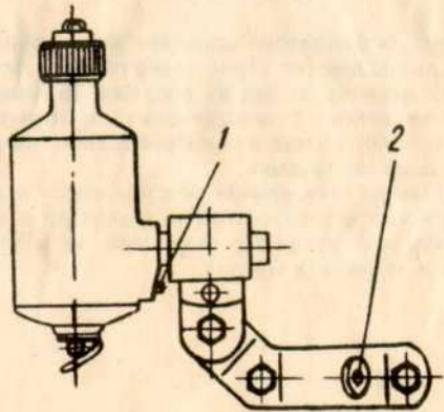
1—винт для крепления крышки к корпусу; 2—винт массы.
