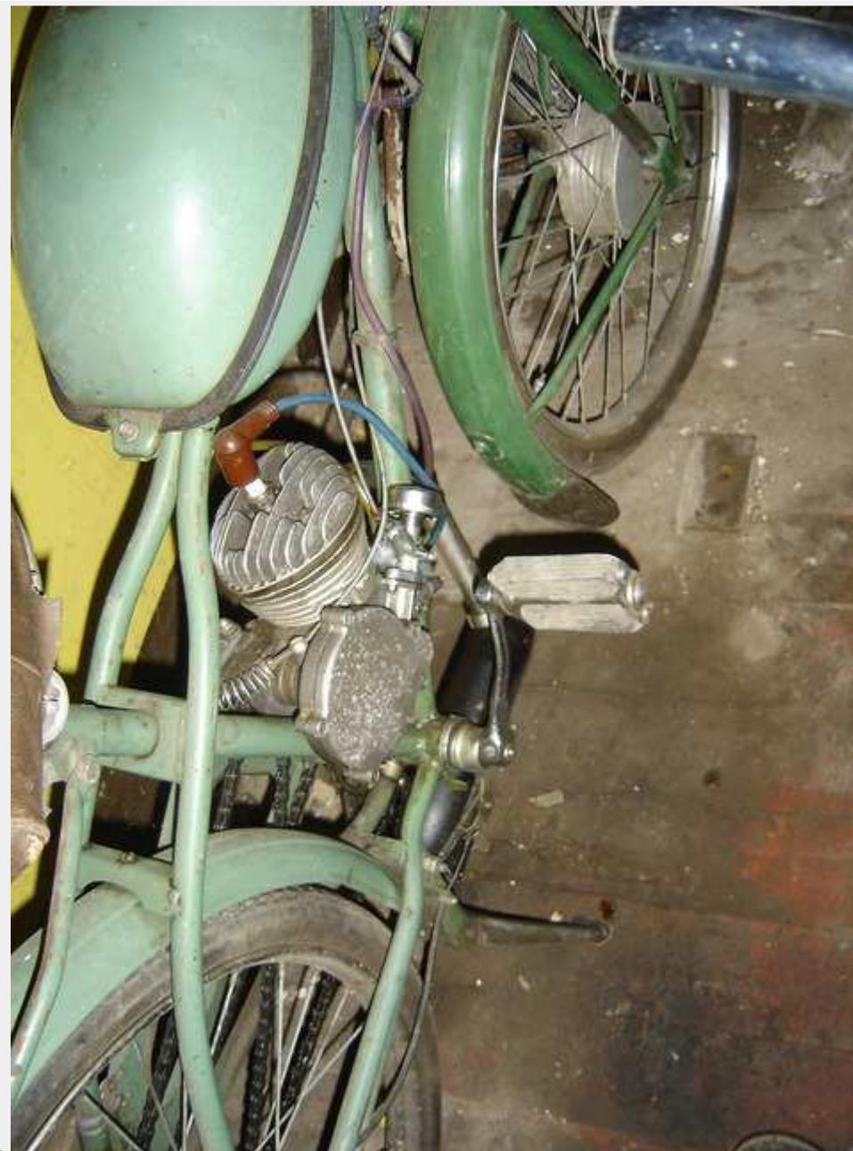
и опять присутствует выштамповка под цепь справа + тормозная тяга.
