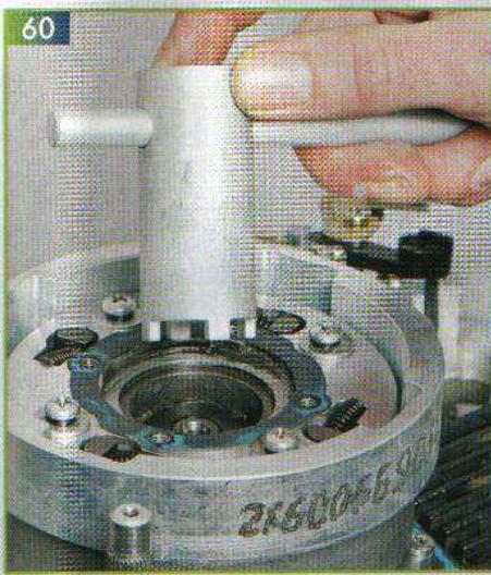
Надеваем приспособление для удержания корпуса сцепления на наружную поверхность корпуса сцепления (59) и специальным корончатым ключом отворачиваем гайку корпуса сцепления (60).
