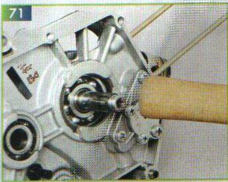
При выпрессовке коленчатого вала запрещается ударять по цапфам какими-либо металлическими предметами. Легкими ударами деревянной или резиновой киянки (или деревянной ручки молотка) по цапфе коленчатого вала (71) выпрессовы-
