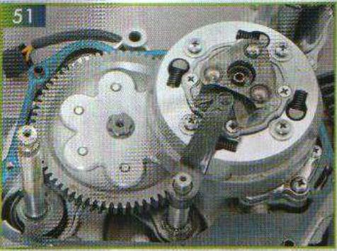
Для доступа к механизму сцепления, как и при полной разборке двигателя, необходимо снять правую крышку картера. Отворачиваем восемь болтов крепления крышки картера. Стык крышки и картера уплотнен картонной прокладкой. Перед снятием крышки двигатель укладываем на
