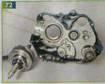
ваем вал вместе с подшипниками (72). При необходимости подшипники коленчатого вала подлежат замене. Для их спрессовывания с цапф коленчатого вала применяется специальный съемник. При снятии и установке подшипников лучше воспользоваться
