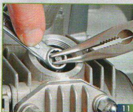
Проворачивать коленчатый вал двигателя можно, нажимая на кикстартер или при помощи трубчатого ключа, надетого на гайку крепления ротора генератора (8).
