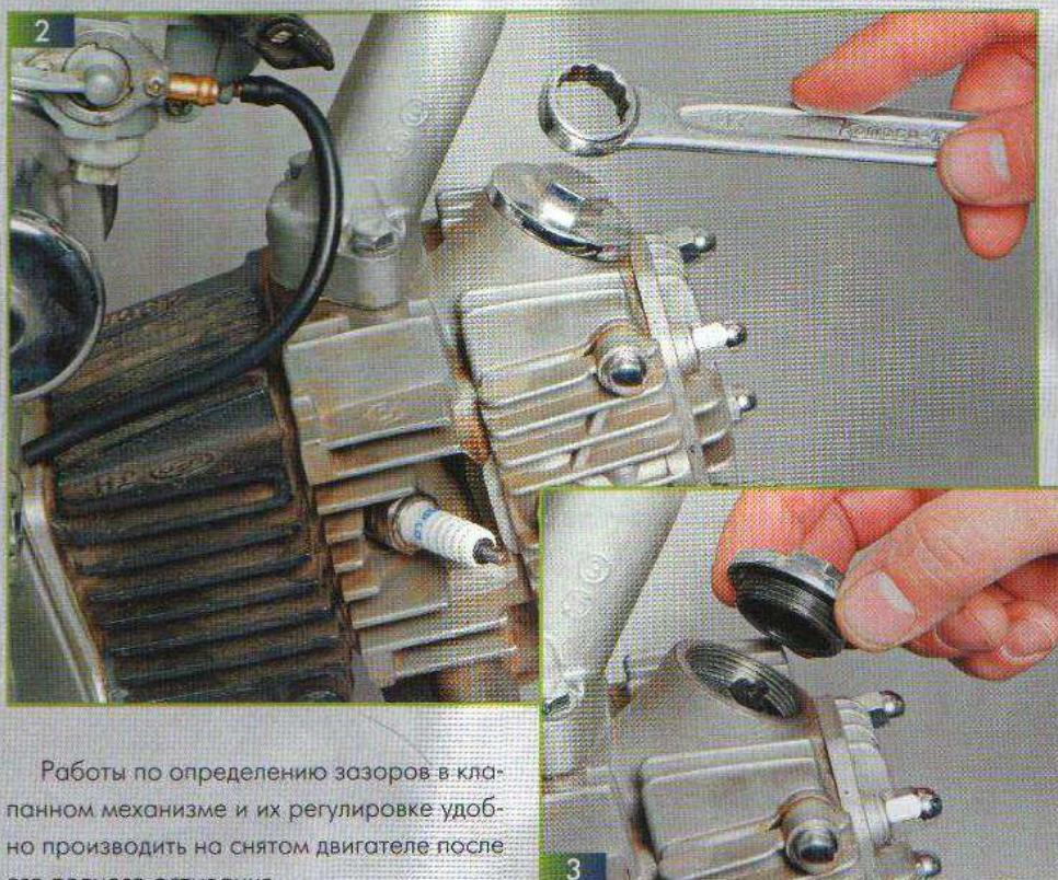
Работы по определению зазоров в клапанном механизме и их регулировке удобно производить на снятом двигателе после его полного остывания.
