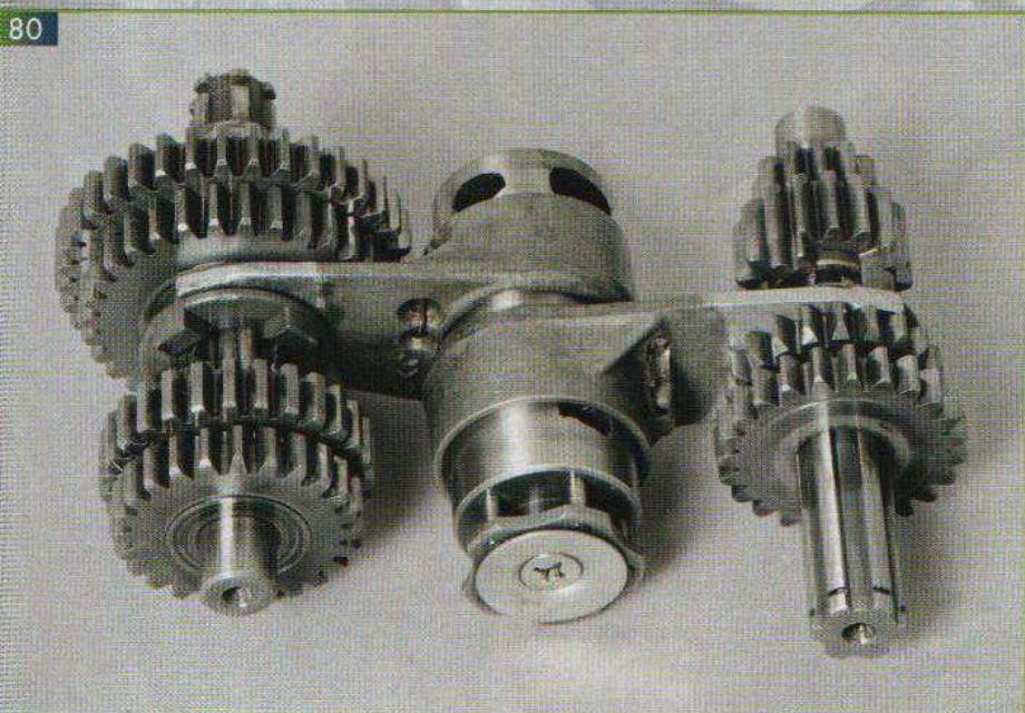
Отворачиваем винт крепления датчика указателя скорости и извлекаем датчик. Шестигранным ключом отворачиваем винт барабана переключения передач. Под винтом расположены контактный элемент и шайба датчика указателя скорости (78). Извлекаем барабан вместе с вилками переключения, валами и шестернями коробки передач (79). При разъединении шестерен, валов и вилок важно не перепутать их местами (80).
