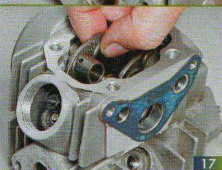
Чтобы извлечь оси коромысел, устанавливаем распределительный вал в положение, соответствующее ВМТ конца такта сжатия. Если вал находится в другом положении, когда клапаны поджаты, монтируем на место звездочку привода ГРМ и фиксируем ее хотя бы одним болтом. Поворачивая звездочку за зубья при помощи отвертки, устанавливаем по меткам нужное положение.
