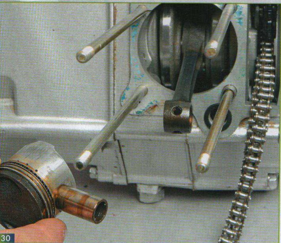
нию клапанов (большая проточка — под впускной клапан). Совмещаем отверстия поршня и шатуна, вдвигаем легкими ударами до упора поршневой палец (предварительно смазав его маслом), после чего вставляем второе стопорное кольцо.
