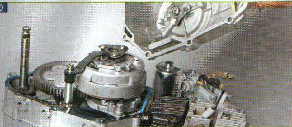
с приклепанным к нему основанием (51). Внутрь основания вставлена втулка с пружиной. Рычаг полуавтомата, сидящий на шлицах вала переключения передач, снимается свободно (52). Для извлечения корпуса сцепления необходимо снять детали полуавтомата выжима: толкатель (пластина с шариками) (53), пружину (54), рычаг сцепления (55), двойную разделительную пластину с роликом и пружиной (56).
