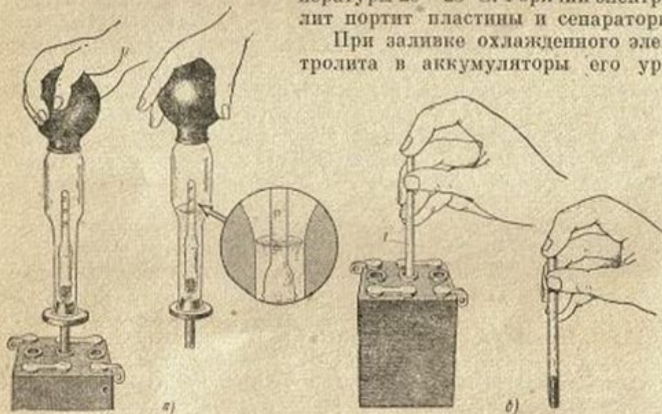
Рис. 99. Измерение плотности и уровня электролита:
