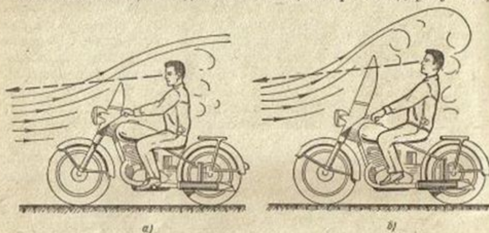
Рис. 184. Установка ветрового щитка мотоцикла: а — правильный; б — неправильный
