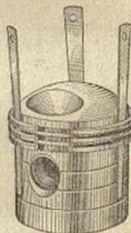
Рис. 33. Снятие и установка поршневых колец с помощью стальных пластинок
