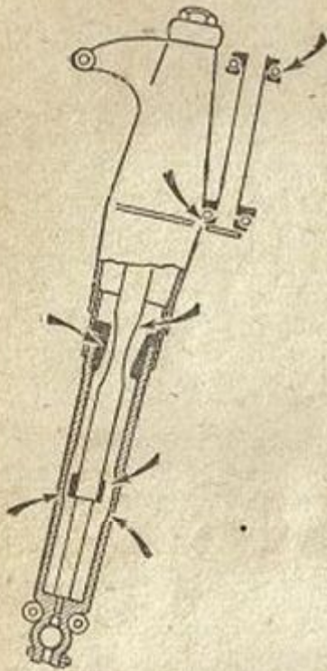
Рис. 181. Места наибольшего износа телескопической вилки
