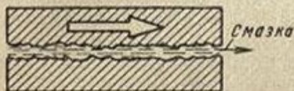
Рис. 60. Шлифованные поверхности при большом увеличении
