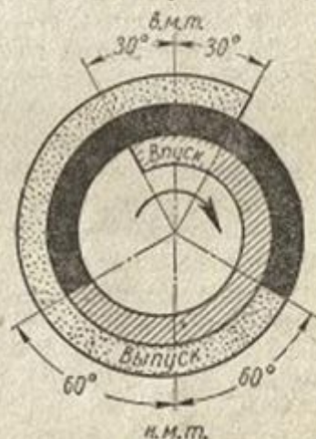
Рис. 48. Диаграмма фаз газораспределения четырехтактного двигателя
