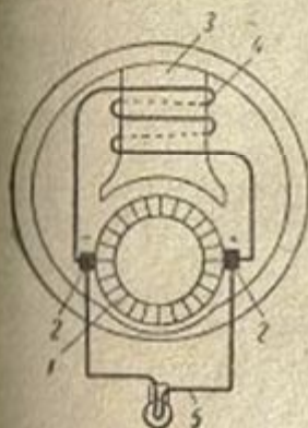
Рис. 81. Схема мотоциклетного генератора постоянного тока с параллельным соединением обмотки возбуждения:
