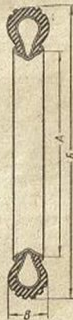
Рис. 182. Монтажные размеры покрышек
