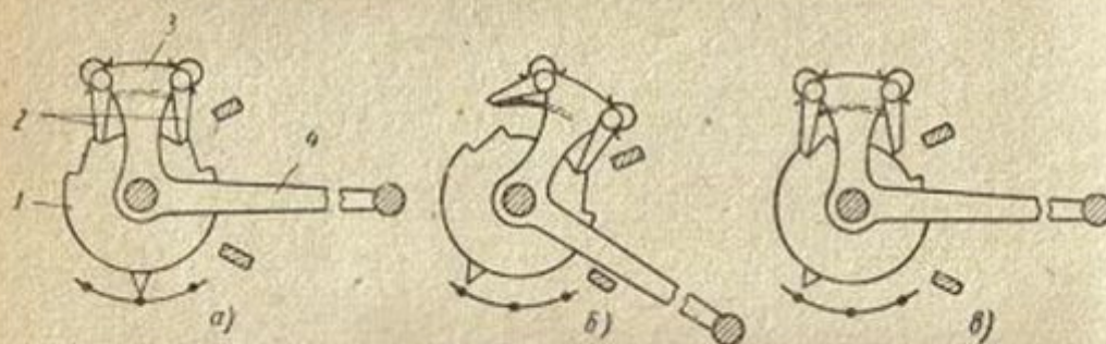
Рис. 145. Схема механизма ножного переключения с селектором:
