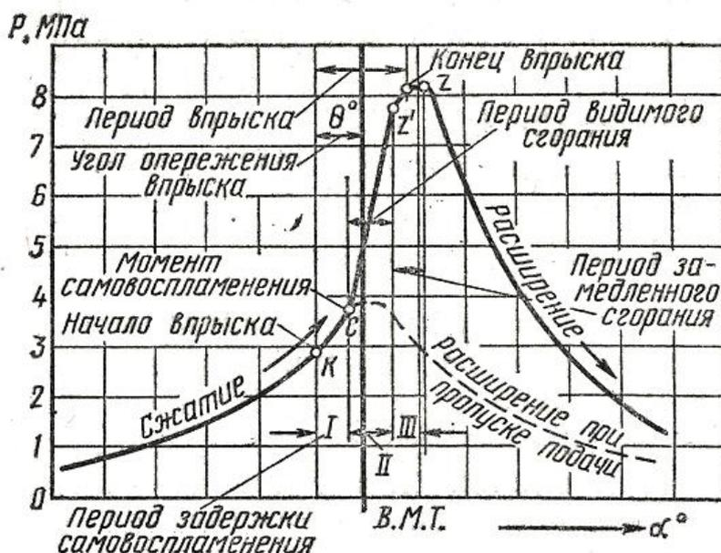
Рисунок 1.2 - Развернутая индикаторная диаграмма дизеля.
