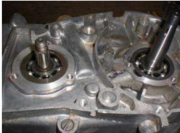
Abbildung 29 Abtriebsseite mit montierten Ausgleichsscheiben
