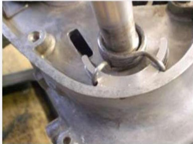
Abbildung 54 Hohlwellenrückstellfeder
