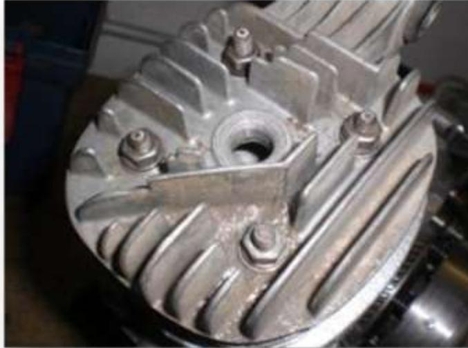
Die Kerze wird mit einem eingestellten Elektrodenabstand von 0,4 eingesetzt und festgezogen.
