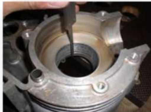
**Abbildung 3 Linke Motorenhälfte mit Tiefenmaß 50,4 mm**
