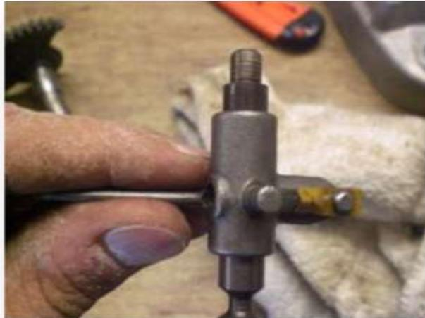
Abbildung 14 Schaltgabel in Leerlaufstellung
