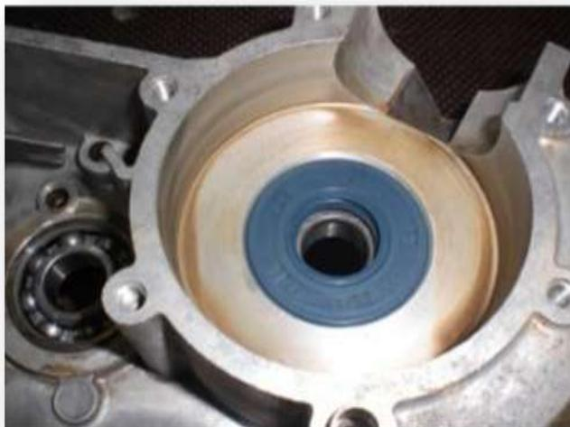
Abbildung 8 Montierter Wellendichtring
