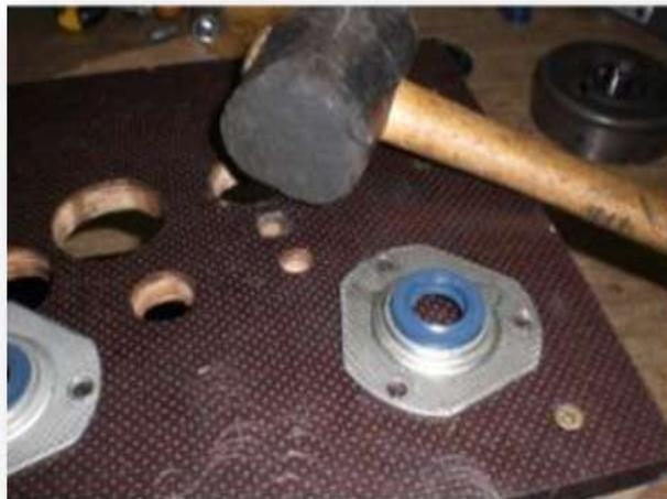
Abbildung 30 Dichtungsdeckel mit montierten WDR
