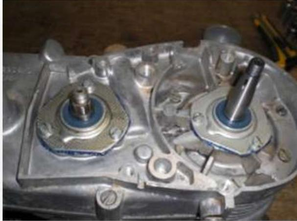
Abbildung 33 Montierte Dichtkappen
