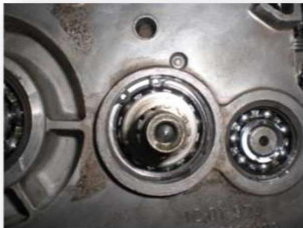
Abbildung 40 Kupplungswelle mit montierter Anlaufscheibe 1 mm
