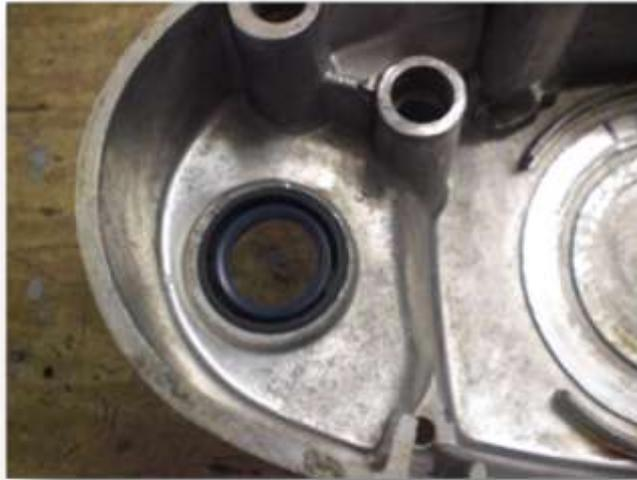
Abbildung 53 Seitendeckel mit neuen Wellendichtring
