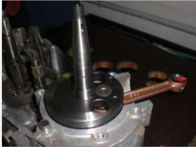
**Abbildung 11 Montierte Kurbelwelle**
