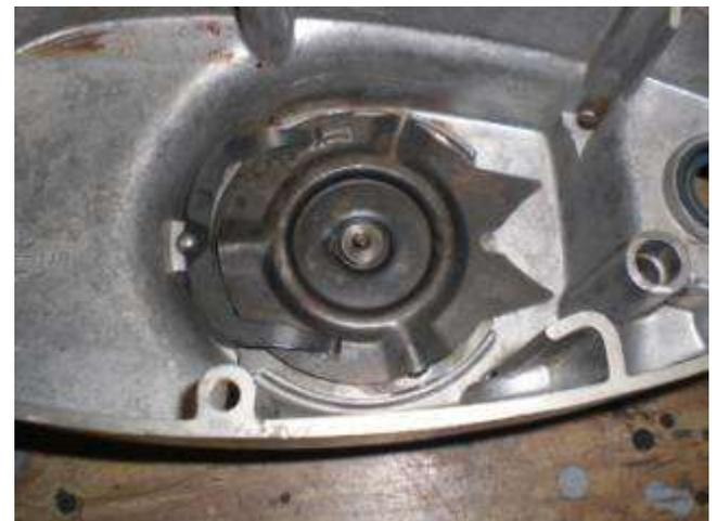
Anschließend wird die Schaltfeder montiert, indem sie einfach an beiden Seiten eingehakt wird.
