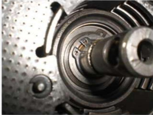
Abbildung 50 Montiertes Paket mit Sicherungsringen
