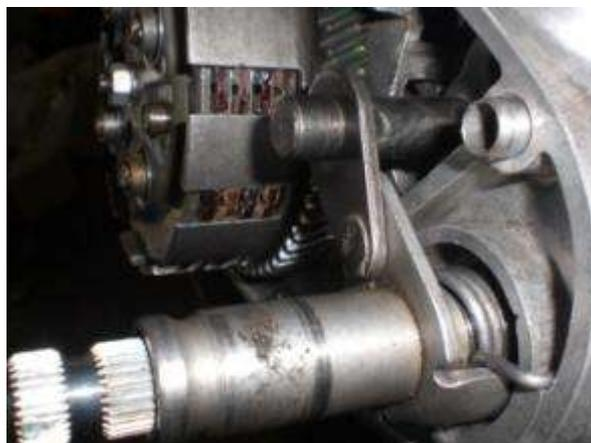
**Abbildung 46 Montierter Schaltmechanismus**
