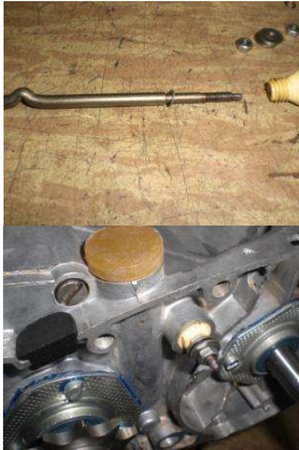
Abbildung 35 Montierte Leerlaufkontaktstange
