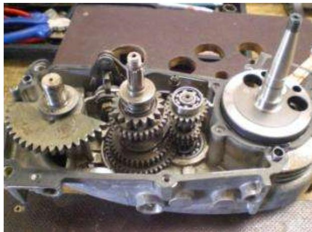
**Abbildung 26 Fertig Montierte linke Gehäsehälfte**
