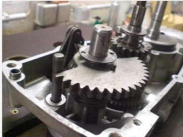
**Abbildung 25 Montierte Kickerwelle mit Anlaufscheibe**
