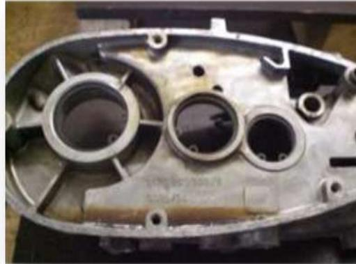
**Abbildung 2 Linke Motorenhälfte mit montierten Sicherungsringen**
