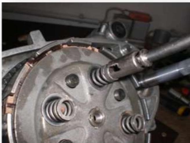
Abbildung 44 Montage Druckfeder mit Spezialwerkzeug
