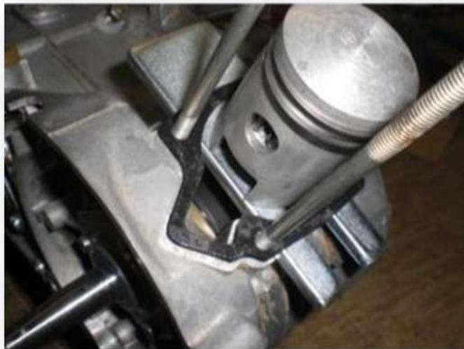
**Abbildung 64 Montierte und leicht geölte Fußdichtung**
