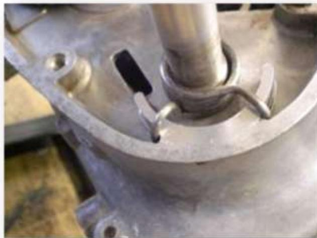
**Abbildung 45 Hohlwellenrückstellfeder**
