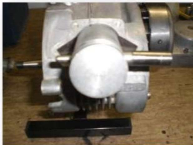
Abbildung 61 Auf Pleul montierter Kolben
