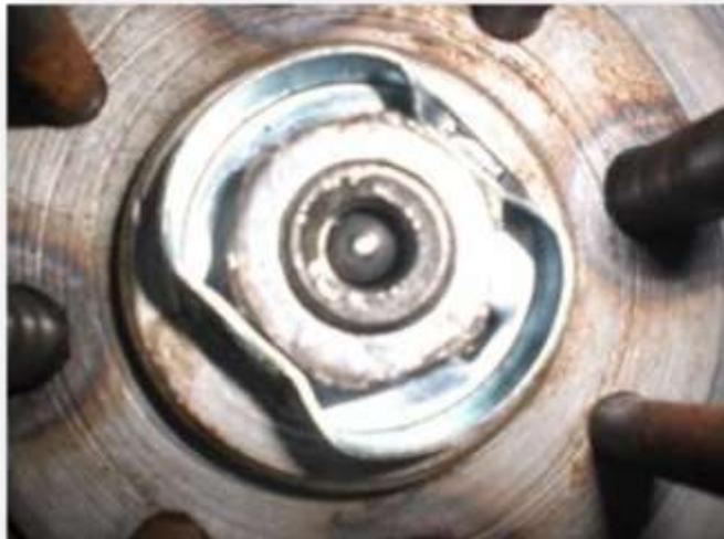
**Abbildung 42 Kupplungsmutter mit Sicherungsblech**
