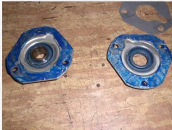
Abbildung 32 Mit Dichtmasse versehene Abdeckkappen
