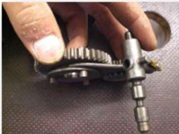
Abbildung 15 Schaltgabel mit beiden Losrädern
