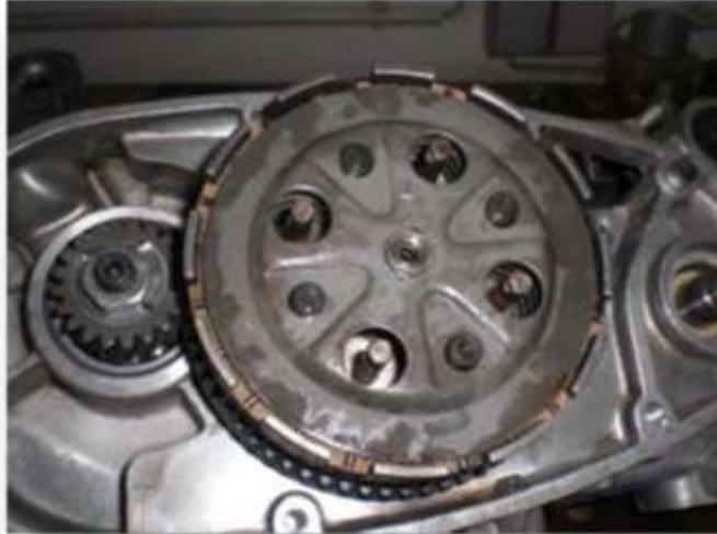
Abbildung 43 Kompletierter Kupplungskorb
