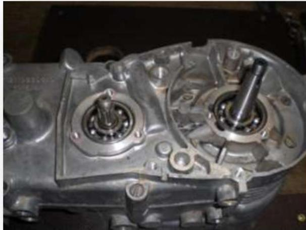
**Abbildung 28** Montierte rechte Gehäusehälfte mit Lager für Abtrieb- und Kurbelwelle
