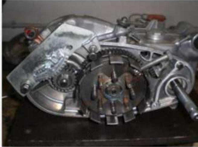
**Abbildung 41 Kompletter Primärtrieb mit Sperrwerkzeug**
