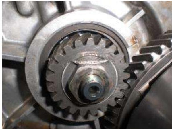
Abbildung 39 Montage Sicherungsblech Primärriittel
