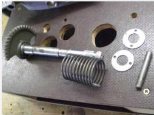
Abbildung 23 Einzelteile Kickerstartereinheit
