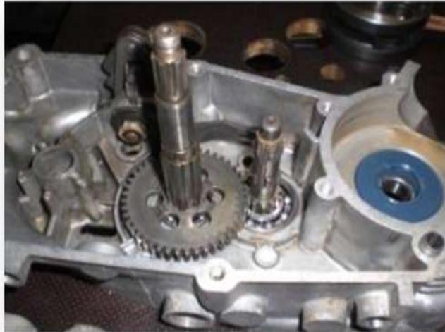
**Abbildung 9** Montierte Kupplung- und Abtriebswelle
