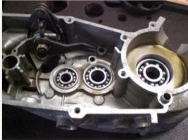
Abbildung 7 Montierte Lager
