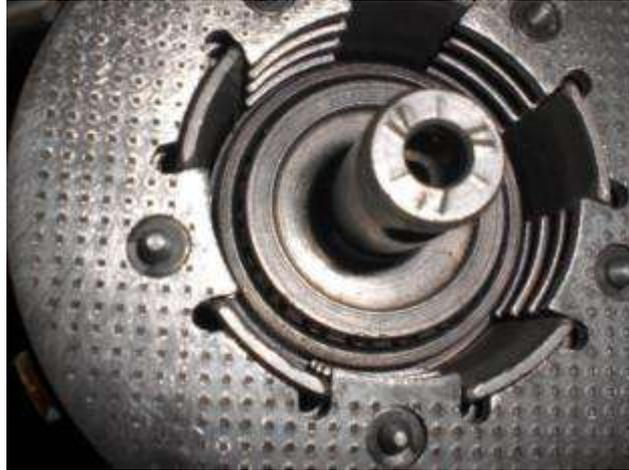
Abbildung 51 Fertig montiertes Lager
