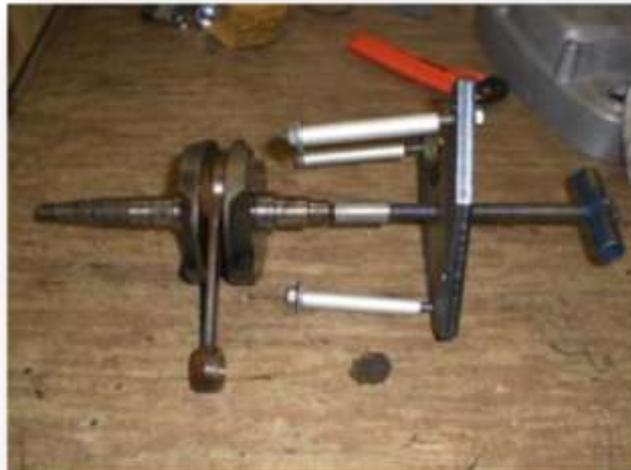
**Abbildung 12 Einziehhilfe für Kurbelwelle**
