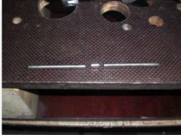
**Abbildung 36 Druckstangen für Kupplung**
