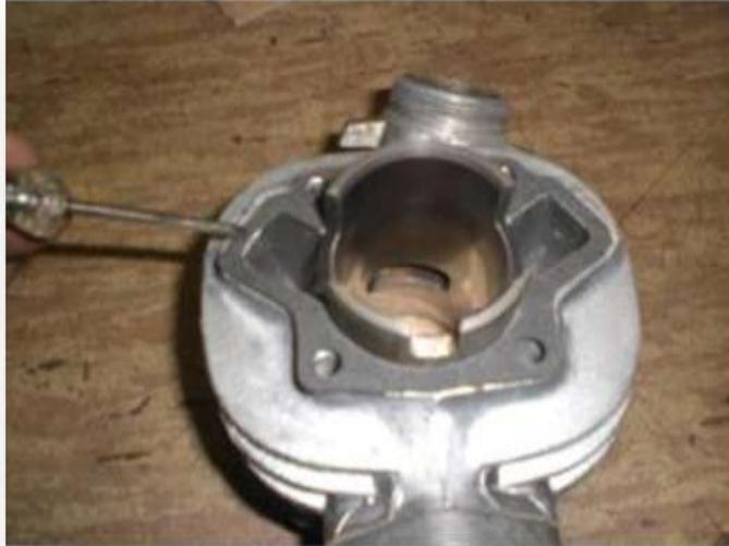
**Abbildung 63 Fußdichtung auf Zylinderboden**
