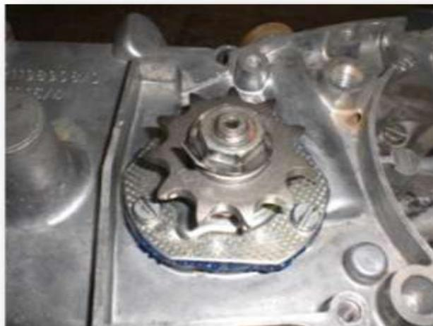
Abbildung 34 Montiertes Abtriebsrad
