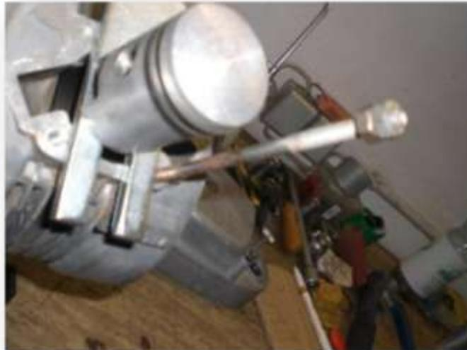
**Abbildung 62 Kolben mit Montagehilfe**
