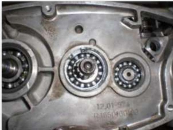
**Abbildung 37 links Kurbelwelle, mitte Kupplungswelle, rechts Abtriebswelle**
