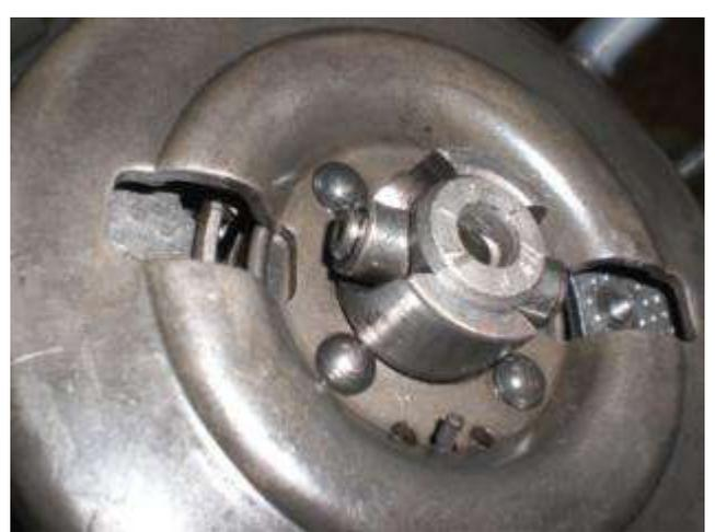
Der Druckstift wird zum Schluss in die Welle gesteckt.
